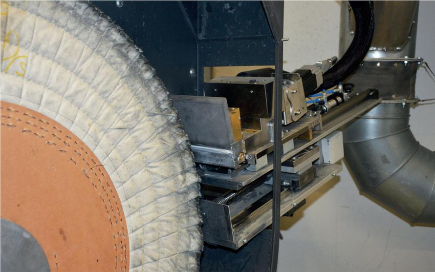
Mit MELT (Menzerna Liquefaction Technology) bringt Menzerna derzeit ein Verfahren zur Serienreife, das die Vorteile von Emulsionen und Festpasten kombiniert. Bei dem sich aktuell in der Pilotphase befindlichen Auftragsverfahren wird feste Polierpaste in einem 200 l-Fass oberflächlich angeschmolzen und über beheizte Leitungen zu einem Dosierkopf am Polierring gepumpt. Das Verfahren ist
