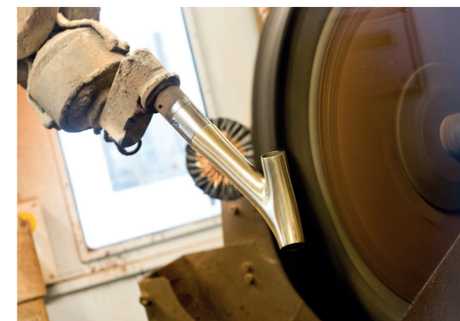
Bild 2: Eine Armatur der Marke AXOR am Polierrad (Werkbild: Hansgrohe Deutschland Vertriebs GmbH, Schiltach)
