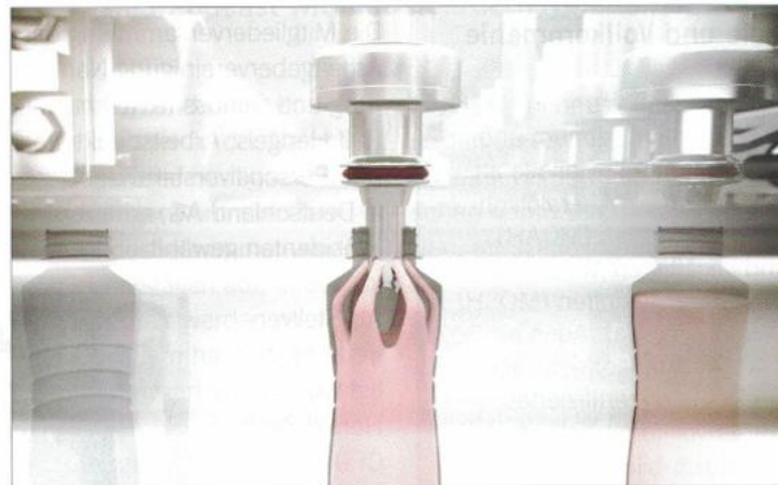
Innovative Technologie für eine aseptische Abfüllung: Um Schaumbildung zu minimieren, taucht der Kolben des neuen Doseurs in die Flasche ein und führt das Produkt über seitliche Öffnungen gezielt entlang der Innenwand.
